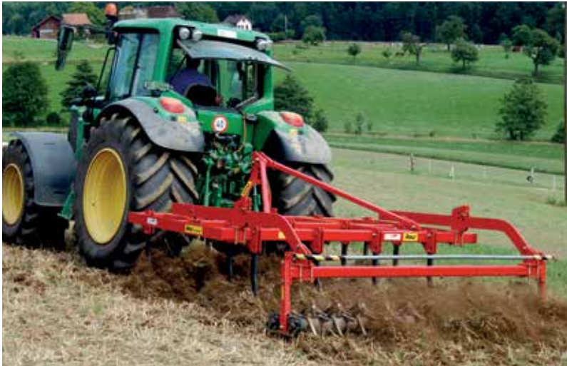
Ce chisel avec double rouleau à pointes est une alternative à la herse à disques. Il peut ameublir le sol en profondeur et le travailler en surface.
