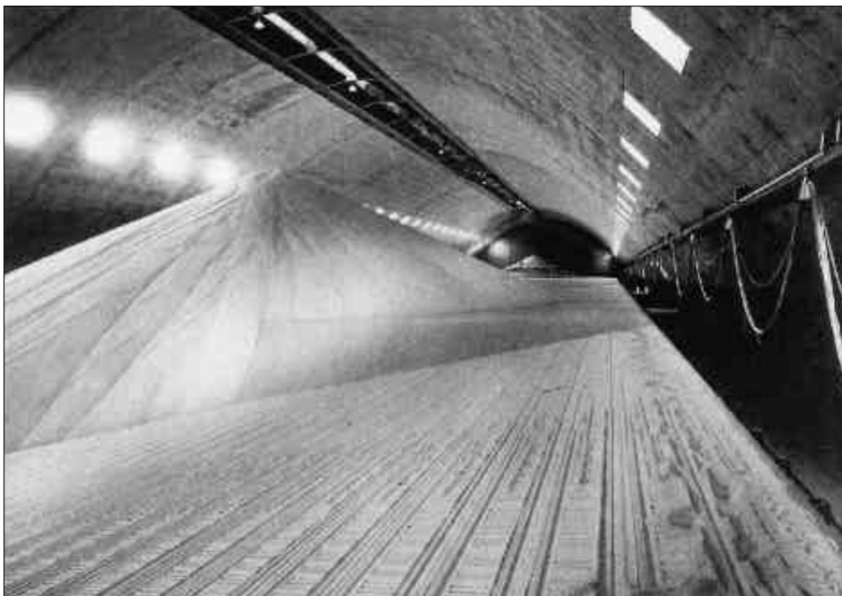
*Magasin de stockage en vrac dans une usine d'engrais.*
