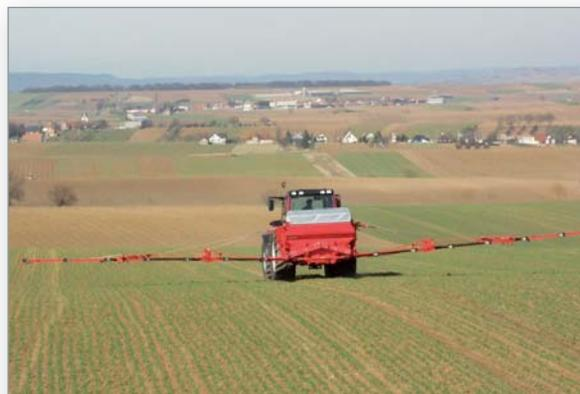
Photo 4.1 : Épandage avec un distributeur pneumatique.
