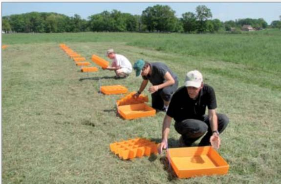
Photo 6.3 : Recueil de l'engrais épanché dans des bacs normalisés.
