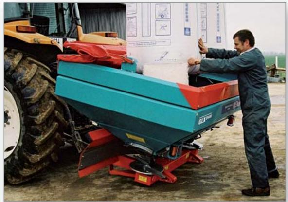
*La vidange de l'engrais est faite dans la trémie pour limiter la hauteur de chute.*
