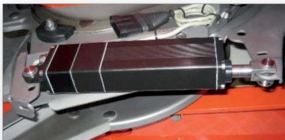
Photo 3.11 : Assistance au réglage de largeur par vérin électrique.
