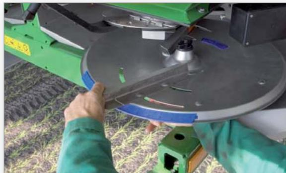
Photo 3.2 : Réglage du distributeur d'engrais.
