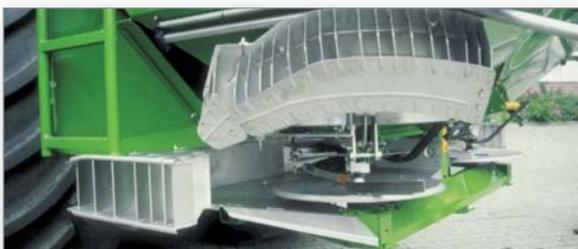
Photo 3.14 : Dispositif d'épandage de bordure relevé.
