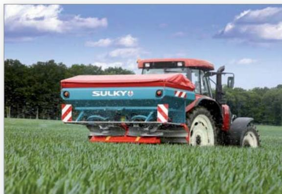
Photo 3.1 : Épandage d'engrais centrifuge.
