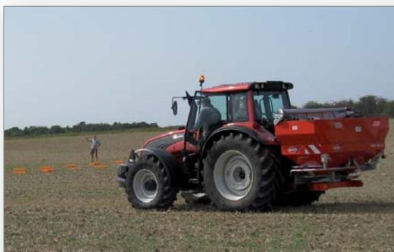
Photo 6.2 : Passage au dessus des bacs pour la mesure de la répartition transversale sur un côté.
